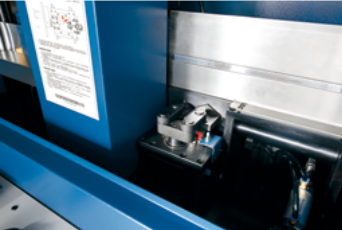
伺服控制模具冲压剪齿机构
